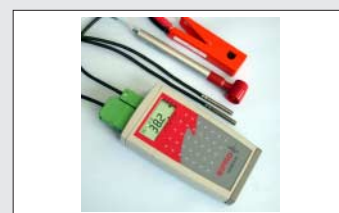
Esempio di monitoraggio aria refrigerata 1 sensore di velocità dell'aria Cod. 3264-B 1 pinza amperometrica Cod. 3268 2 sensori NTC -50..+140°C Cod. 3090-L10
