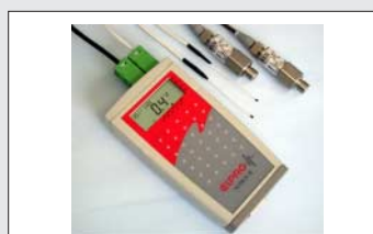
Esempio di utilizzo per pressione 1 sensore di pressione -1..9 bar Cod. 3280-A 1 sensore di pressione -1..24 bar Cod. 3280-B 2 sensori NTC -50..+140°C Cod. 3055-L03
