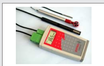
Esempio di monitoraggio parametri ambientali 1 sensore hygroclip Cod. 3088-A 1 cavo di estensione da 1m Cod. 3216-L01 1 sensore di velocità dell'aria Cod. 3264-B 1 sensore NTC -50..+140°C Cod. 3090-L10
