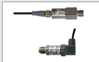
Sensore di pressione, acciaio inox, 4..20mA -1..9 bar G 1/4" Cod. 3280-A -1..24 bar G 1/4" Cod. 3280-B Baro: 0.8..1.2 bar, G 1/2" Cod. 3255-A
